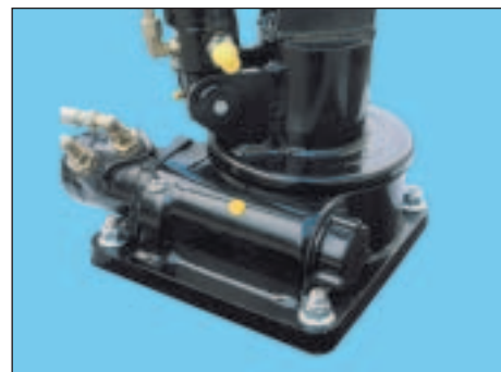
Das Schwenksystem ist in einem mit O-Ring abgedichtetem Kranfuß aus Stahl eingekapselt und somit vor Wasser und Schmutz geschützt.
